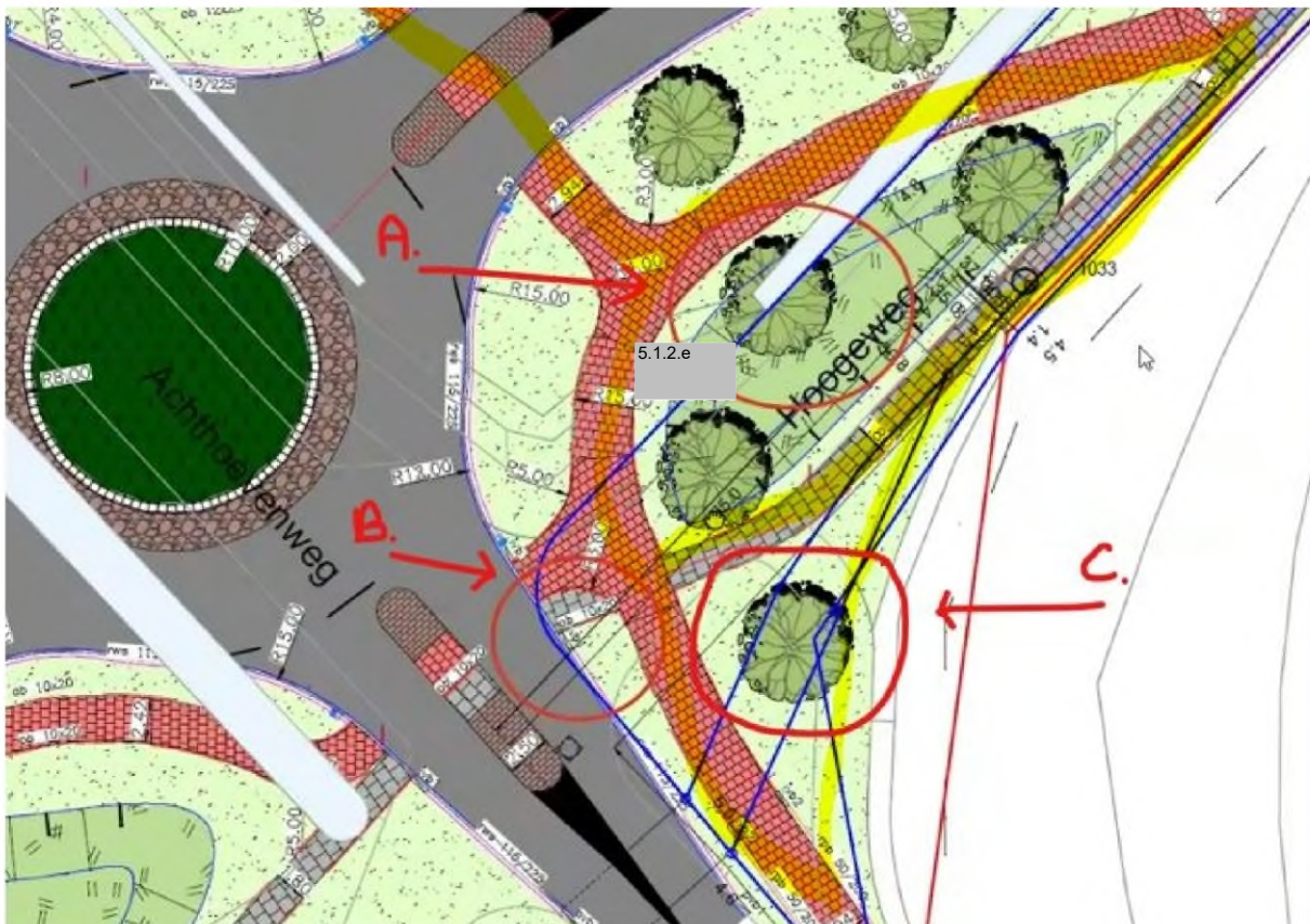
Figuur 1 nieuw ontwerp met knelpunten.
