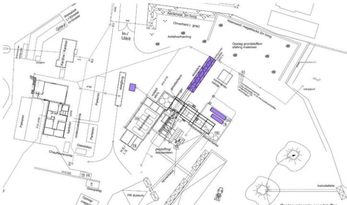
Afbeelding 1.3: bestaande situatie (van links naar rechts in het paars: weeghuisje, eindsilo's en bitumentanks)
