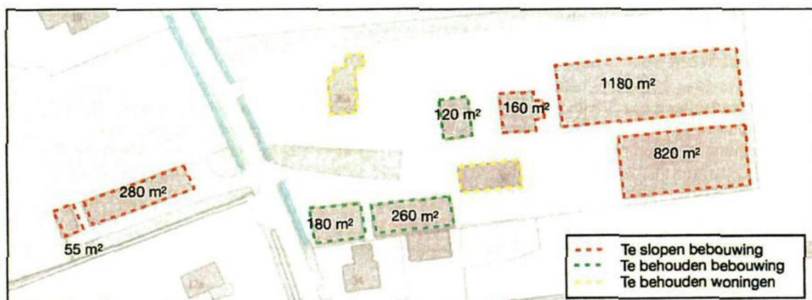
Afbeelding 4: Te slopen en te behouden bebouwing Rondweg 36
