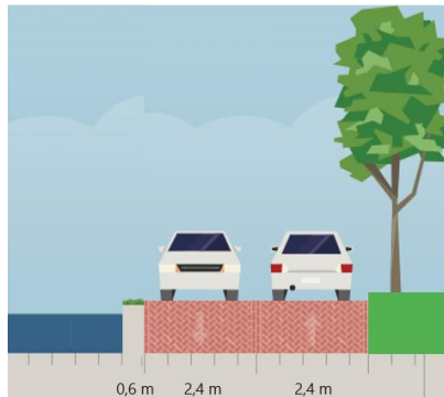
Figuur 6.3: Voorkeursprofiel ontsluitingsweg langs Entergraven
