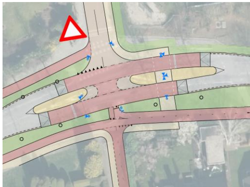
Figuur 6.7: Kruispunt Bornerbroekseweg – Sportlaan met verkeersregelininstallatie (VRI)
