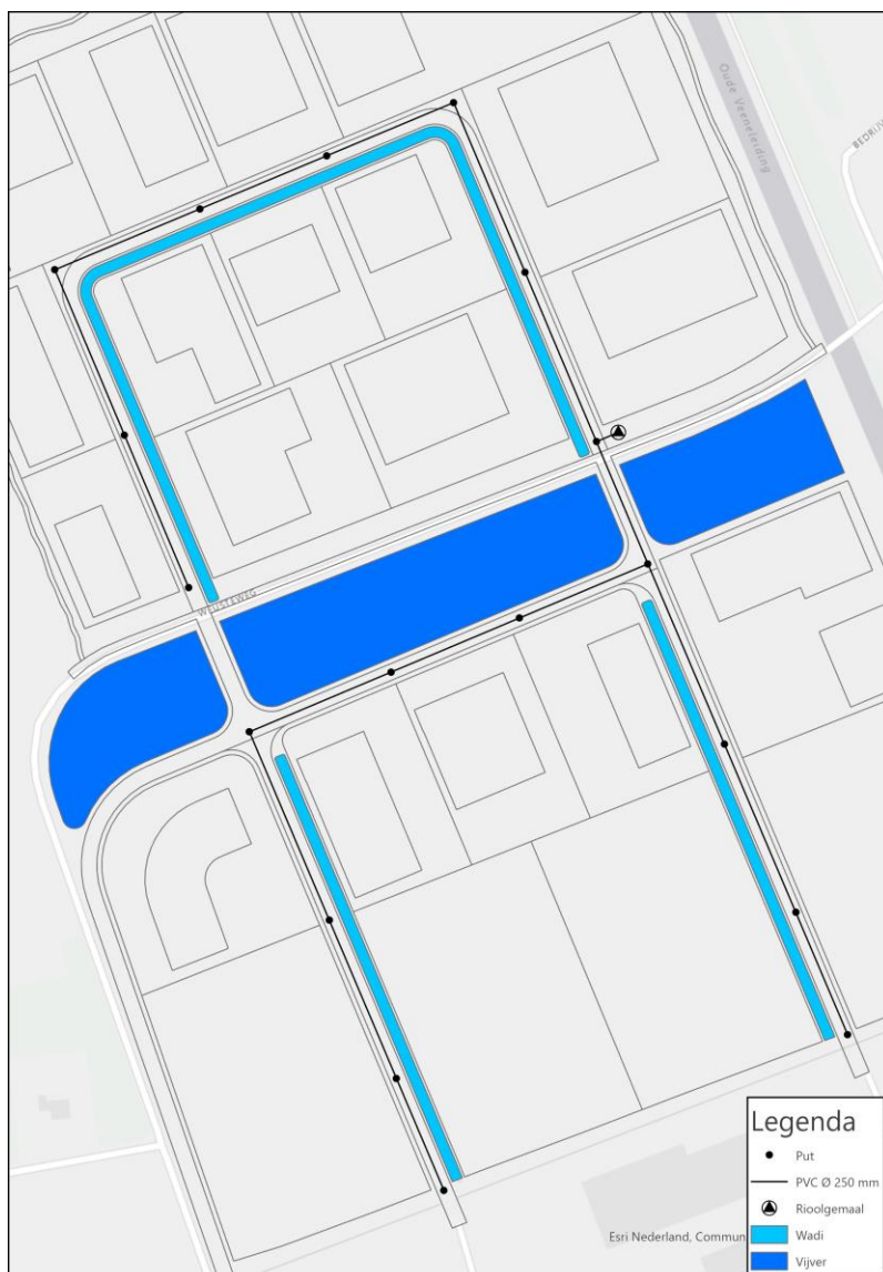
Afbeelding 3.7: Afvoer vuilwater en locatie rioolgemaal
