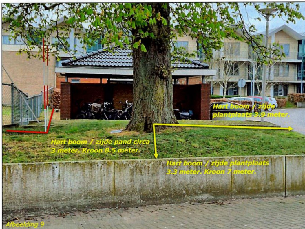
Afbeelding 9: Met jalons zijn de contouren van het nieuwe pand weergegeven. Gezien het feit dat de fundatie ruimer uitgekist dient te worden, zal dit binnen de kroon, maar ook binnen de stabiliteitskluit van de boom plaatsvinden.
