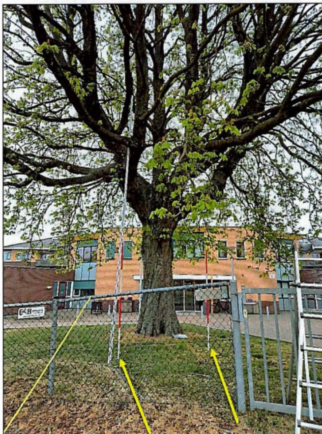
Afbeelding 8: Met jalons zijn de hoeken van het pand weergegeven; rechts volgens plan en links het alternatieve plan. In beide gevallen recht onder de kroon.
