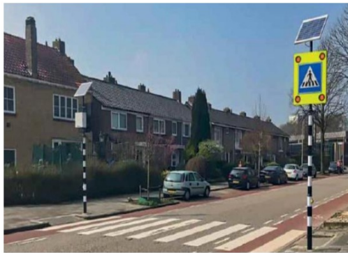
Figuur 6.6: Voorbeeld zebra pad met waarschuwingslampen
