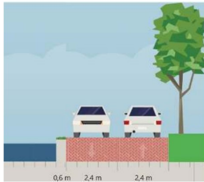
Figuur 6.3: Voorkeursprofiel ontsluitingsweg langs Entergraven
