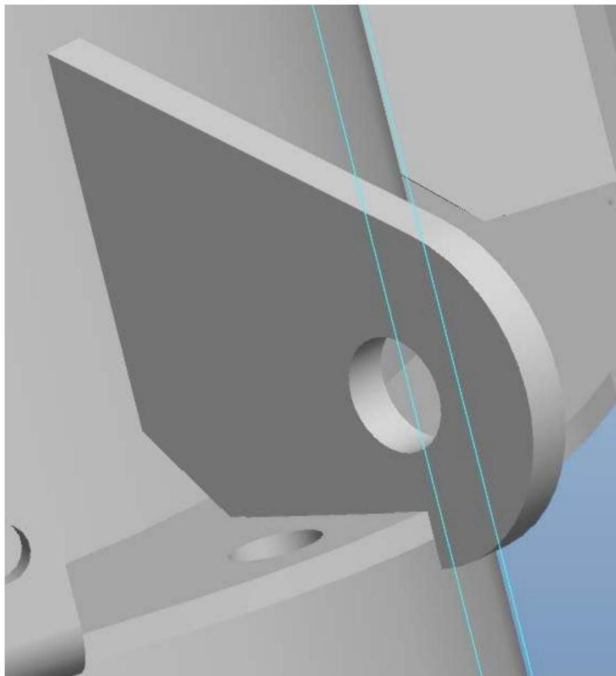
hole diameter  $\phi_i := 20\text{mm}$
