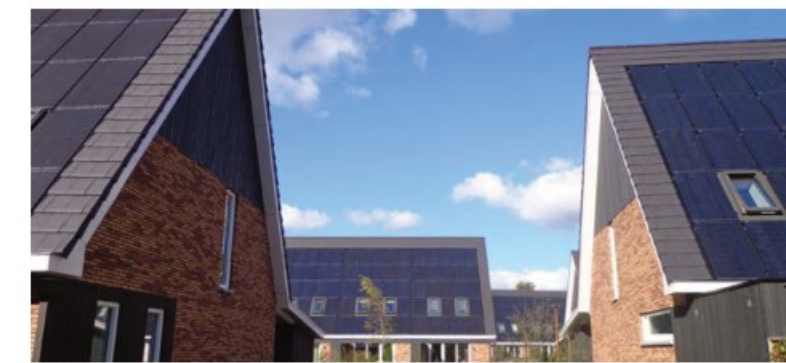
PV cellen worden geïntegreerd in het kapontwerp
