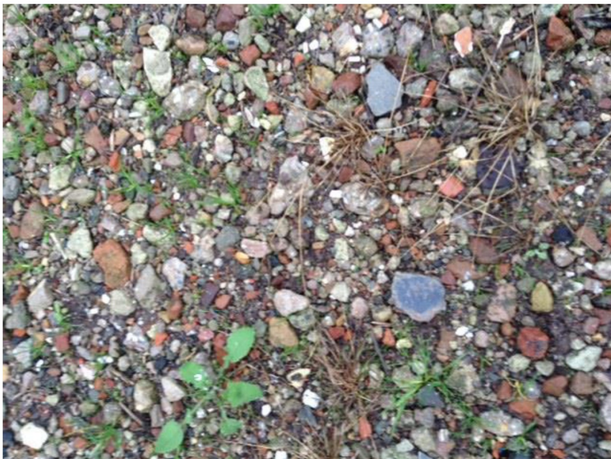
Foto 7: stukjes asbest verdacht materiaal t.p.v. aanwezige puinlaag
