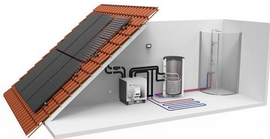
Figuur 6.7 | PVT-paneel gekoppeld aan warmtepomp. Bron: Qsilence
