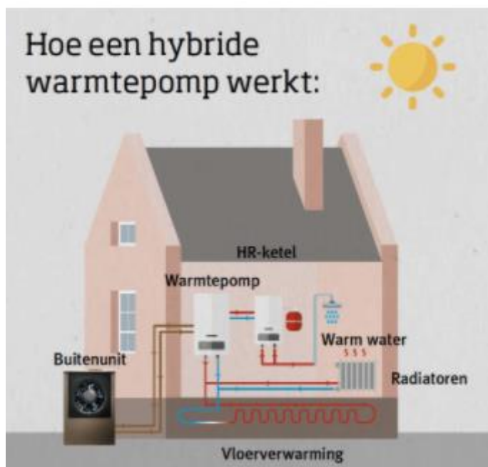
Figuur 3-4: Werking hybride warmtepomp [Bron: www.instalcenter.nl ]
