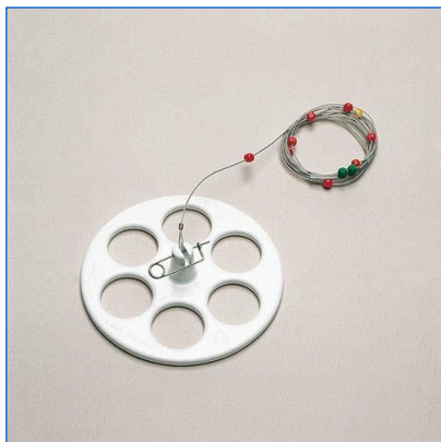
Figuur 16 Een Secchi schijf om het doorzicht te meten. Het doorzicht is de diepte waarop de schijf net niet meer te zien is. Deze diepte kan afgelezen worden aan de kraaltjes die op een onderlinge afstand van 20 centimeter vast zitten aan de kabel waaraan men de schijf laat zakken. Bron figuur: Eijkelkamp Soil & Water).
