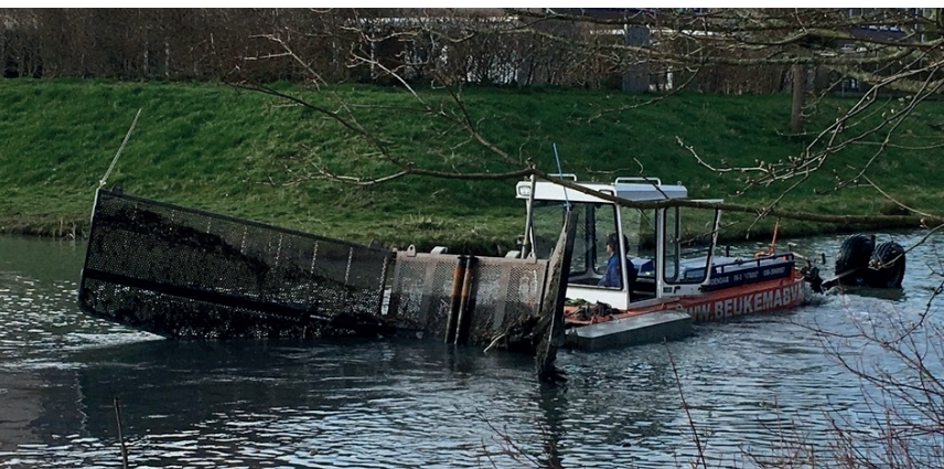
Er kan met een kraan vanaf de waterkant gebaggerd worden of vanaf het water per boot. Een groot deel van het hoofdwatersysteem zuidwest Groningen wordt per boot gebaggerd.
