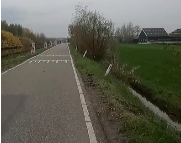
Afb. 3: Voorbeeld van zachte berm en talud nabij kantlijn
