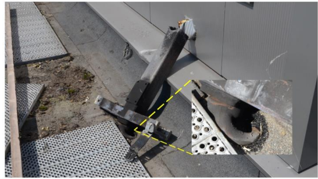
Afbeelding 16: Aangetroffen hijsbeugel, onderdeel van de accumulatorenhouder foto's TBO VRHM
