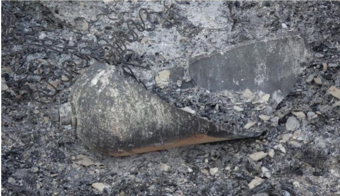
Afbeelding 28 Foto TBO Hollands Midden; afgescheurd deel (fragment) van de drukhouder
