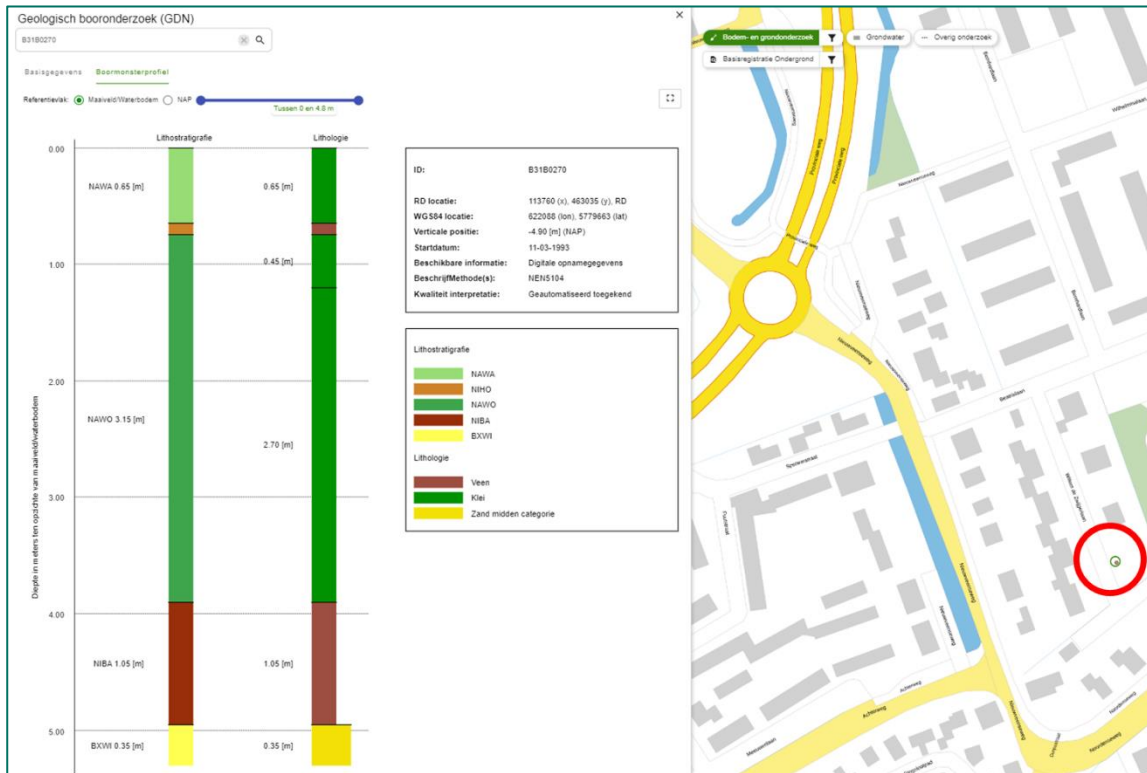
Figuur 17: Grondwatermonitorsput, Boormonsterprofiel
