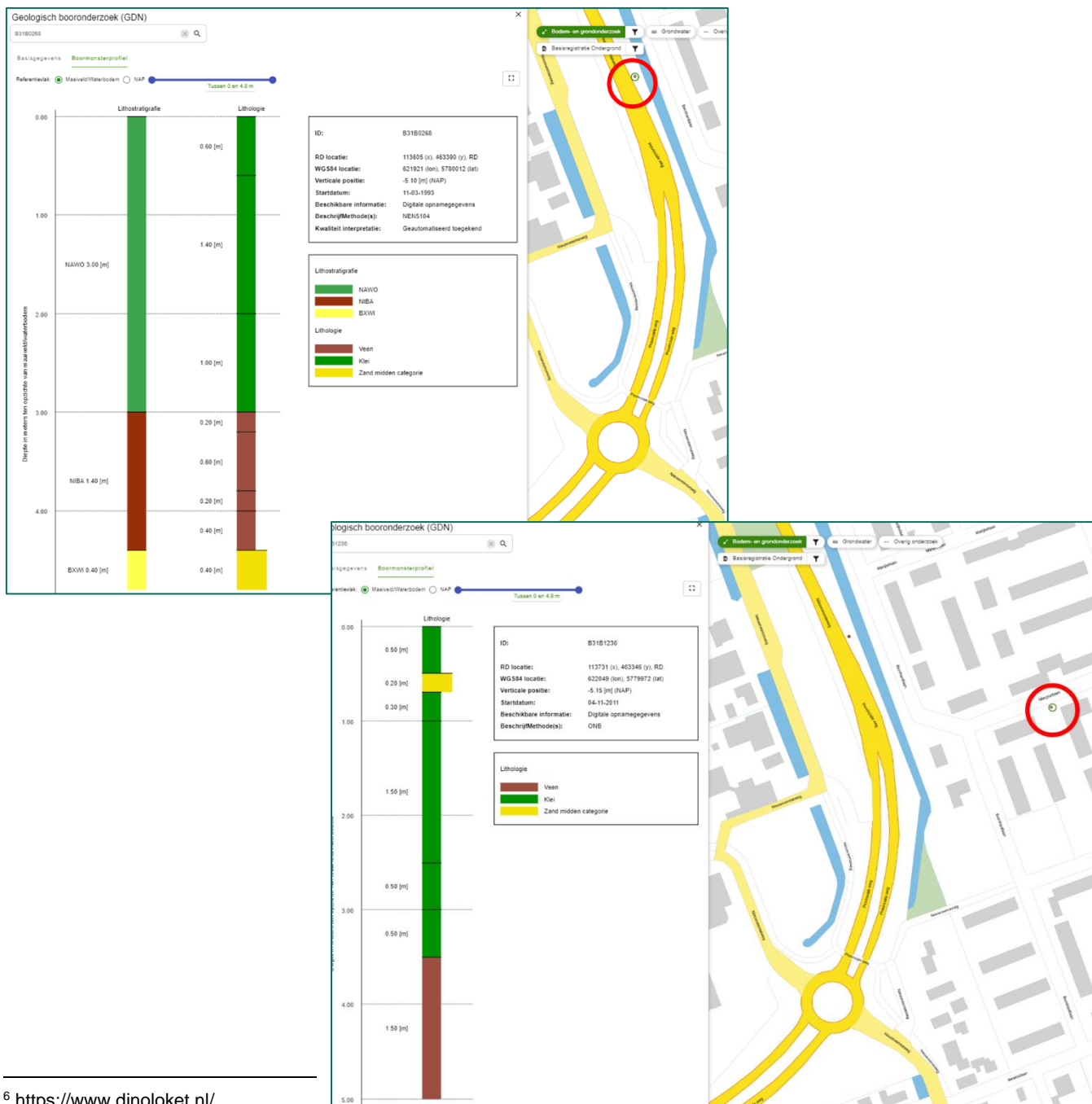
Figuur 16: Grondwatermonitoringsput, Boormonsterprofiel
