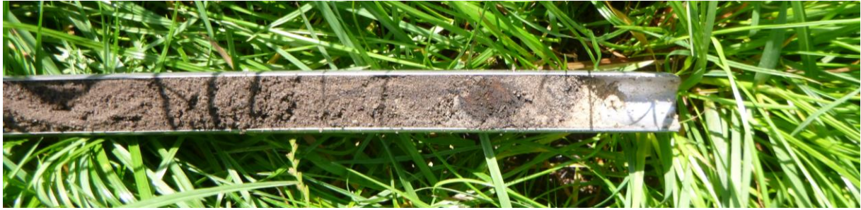
Figuur 10: De zandlaag met veenbrokken zoals deze op de boorpunten 20 tot en met 24, 26 en 27 is aangetroffen. Helemaal rechts is het grijze zand van de C-horizont te zien met net iets links daarvan, een duidelijk veenbrok.
