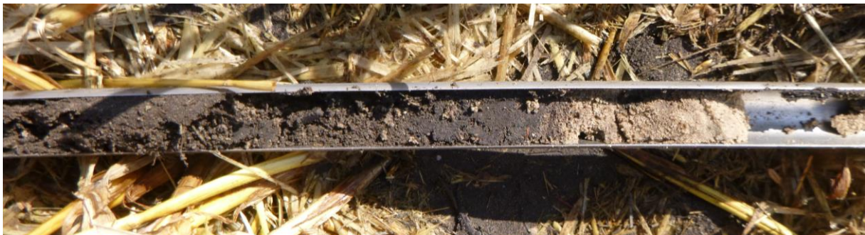
Figuur 3: Foto van de moerige zandlaag (links) op een dun laagje veen (midden) zoals deze in de boringen 8 en 10 is aangetroffen.
