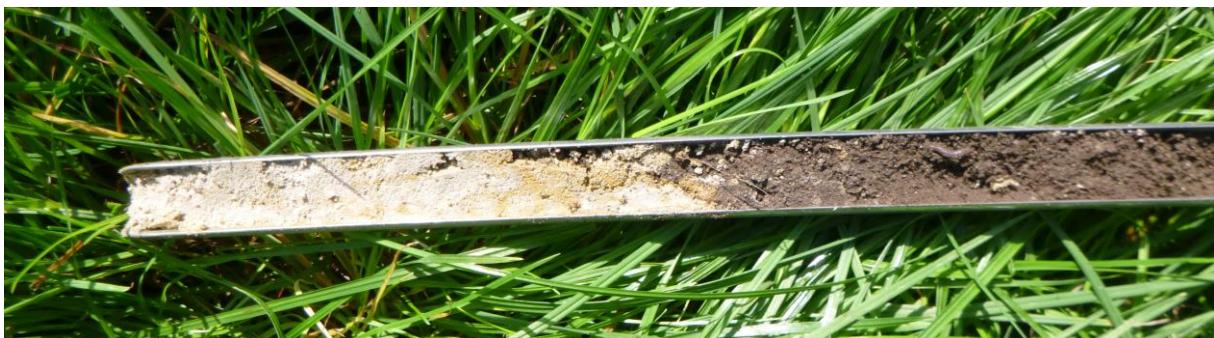
Figuur 7: De gley-horizont (midden) zoals deze op de boorpunten 3 en 6 is aangetroffen.
