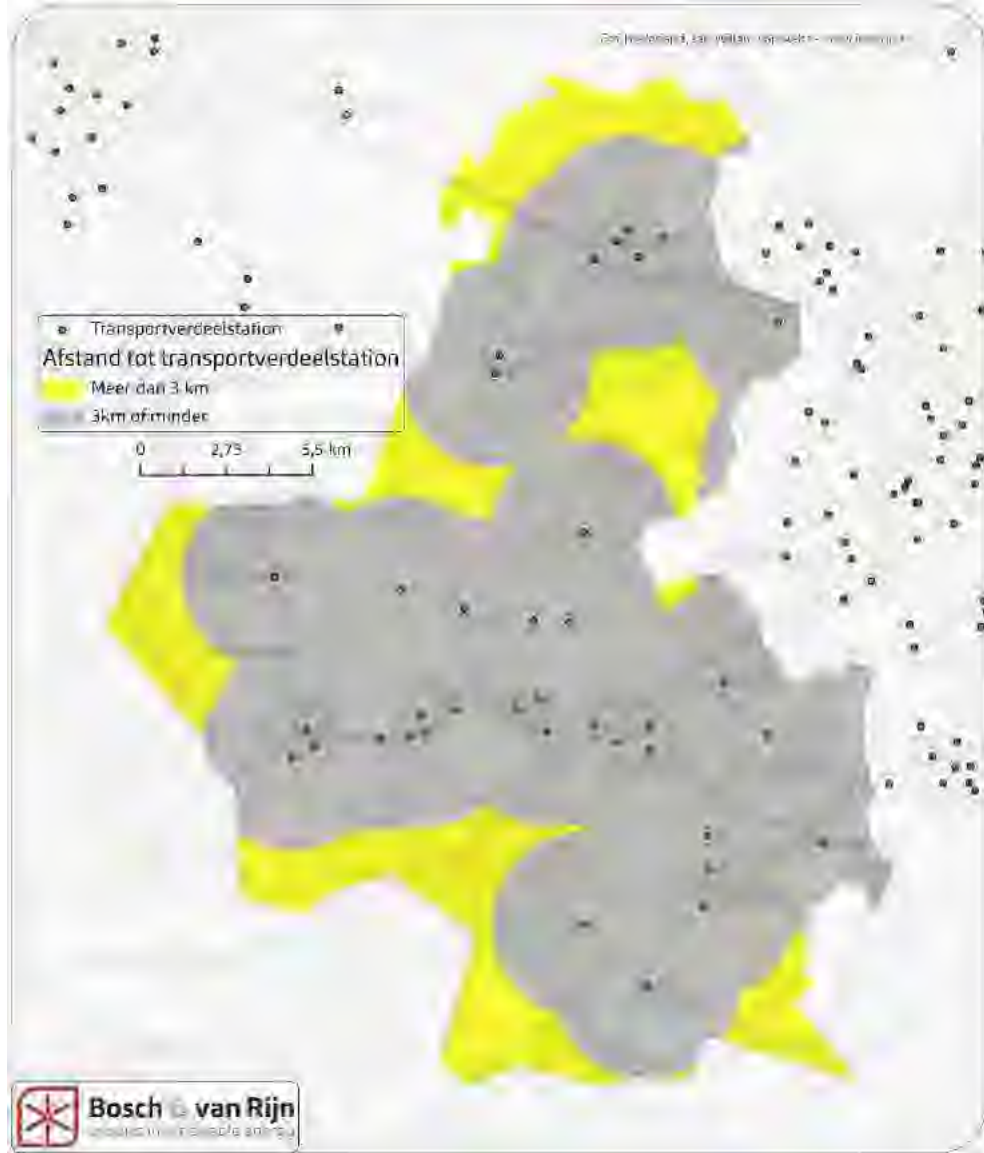
Figuur 52 Gebieden binnen 3km van een transportverdeelstation zijn geschikter voor inpassing van kleinere zonneprojecten (tot 8 hectare) doordat de kosten van de verbinding met het transportverdeelstation beperkt zijn. Voor grotere zonneparken (>8 ha) geldt dat zij de kosten van een langere kabel kunnen 'dragen'.
