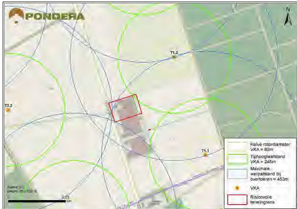
Figuur 5.8 Weergave propaanopslag gelegen binnen PR10 -08 contour van windturbines
