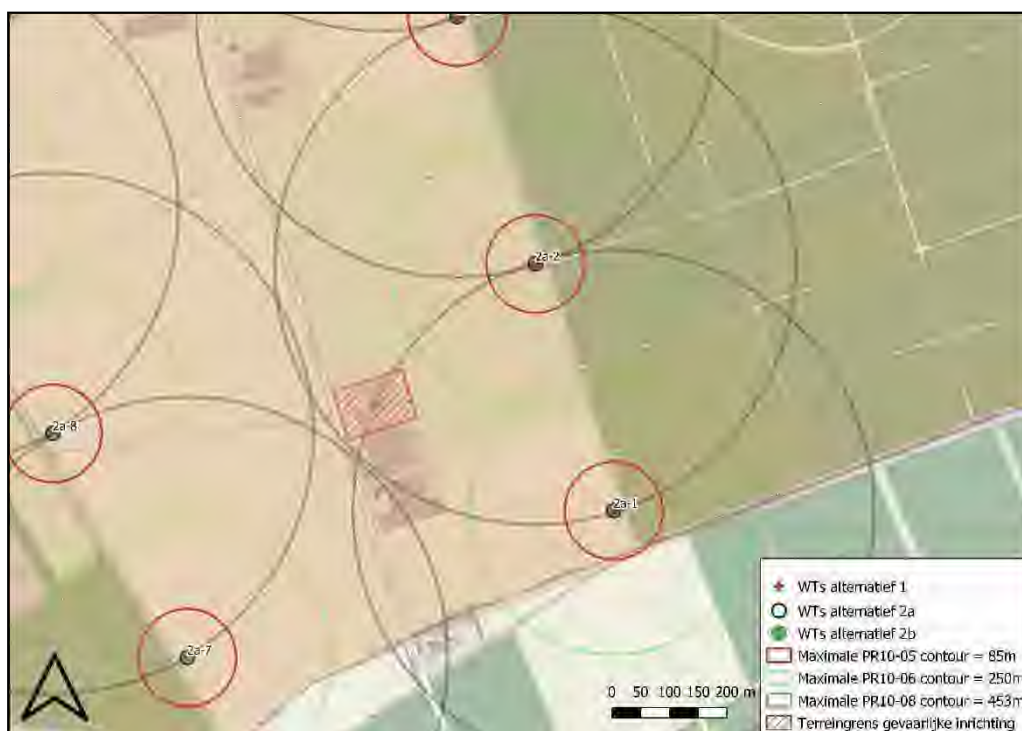
Figuur 12.5 Weergave propaanopslag gelegen binnen PR10-08 contour van windturbines
