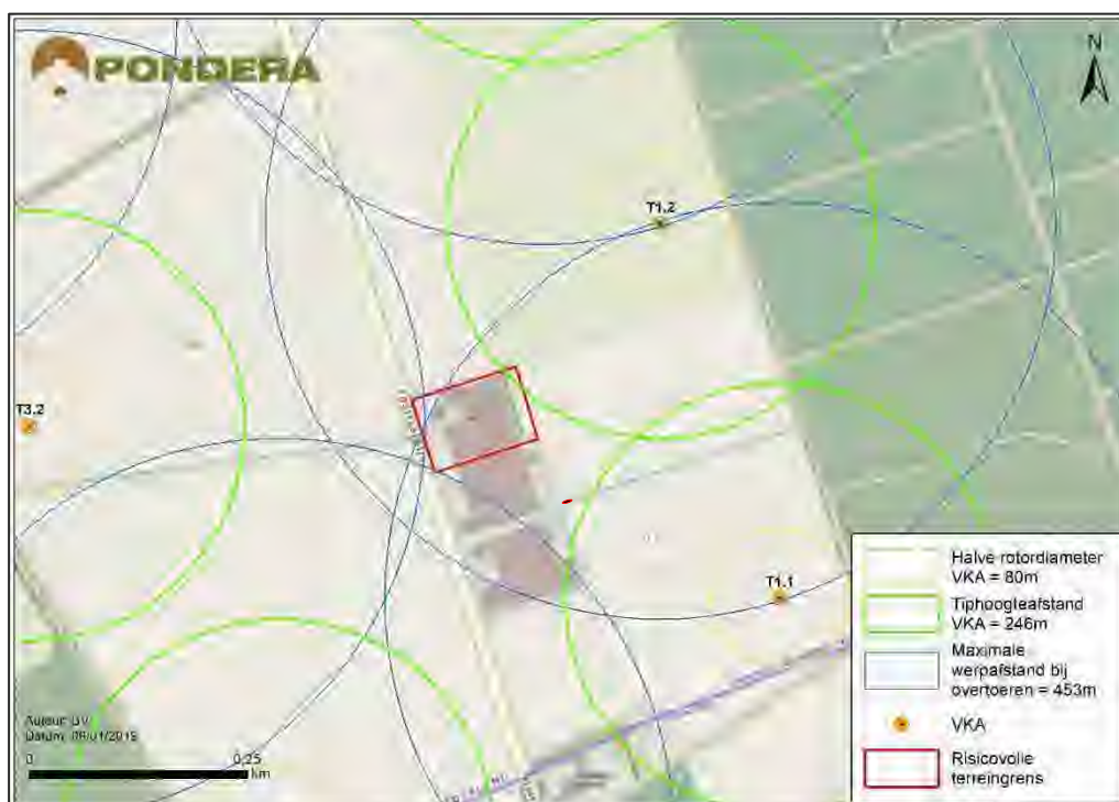
Figuur 17.14 Weergave propaanopslag gelegen binnen PR10-08 contour van windturbines
