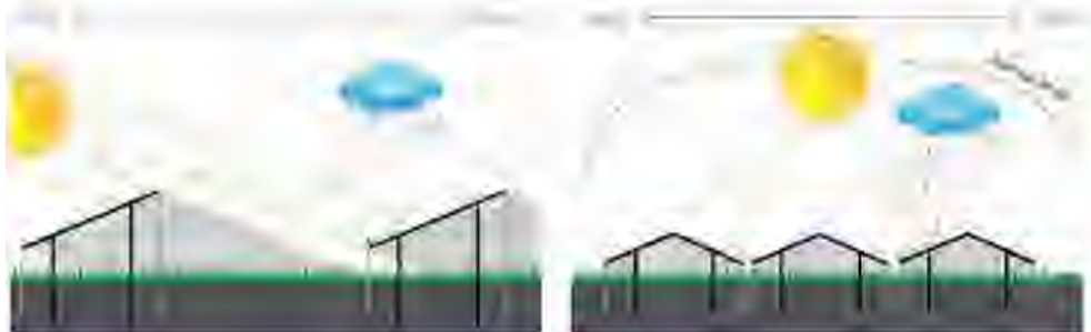
Figuur 48 Voorbeeld zuidopstelling (links) en oostwest-opstelling (rechts) (bron: Kok et. Al., zonneparken en bodemafdekking).
