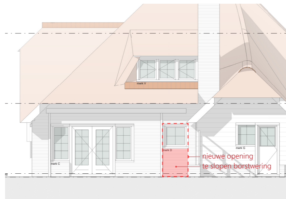
De noordoostgevel in bestaande situatie, schaal 1:100.
