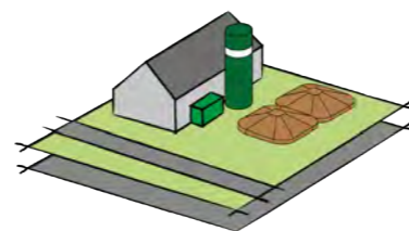
Kleinschalige boerderijvergister Hoogte: 12 meter; 100 m 2 grondbeslag
