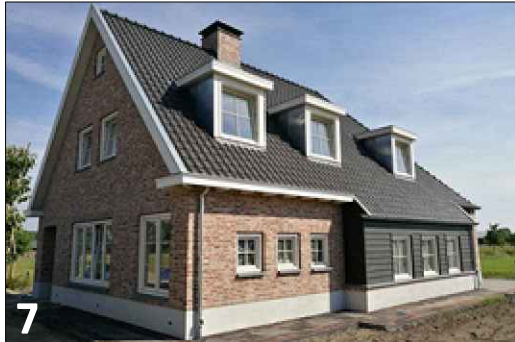
Vierkante gevelgeleding met toepassing van divers gevelmateriaal (stuc, hout en metselwerk)
