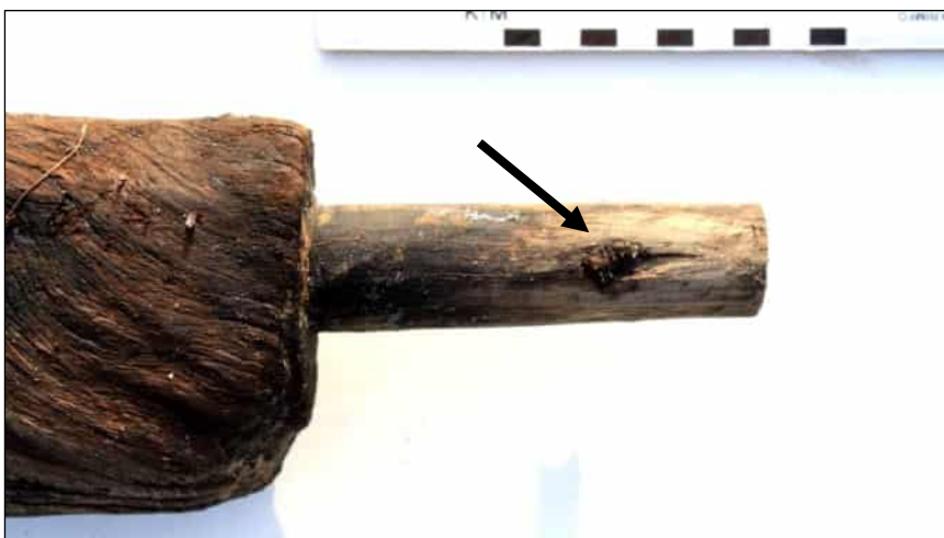
Fig. 12. Eikenhouten penrestant (zie pijl) in uiteinde van verbindingspen; S106.26 (© BIAX Consult).
