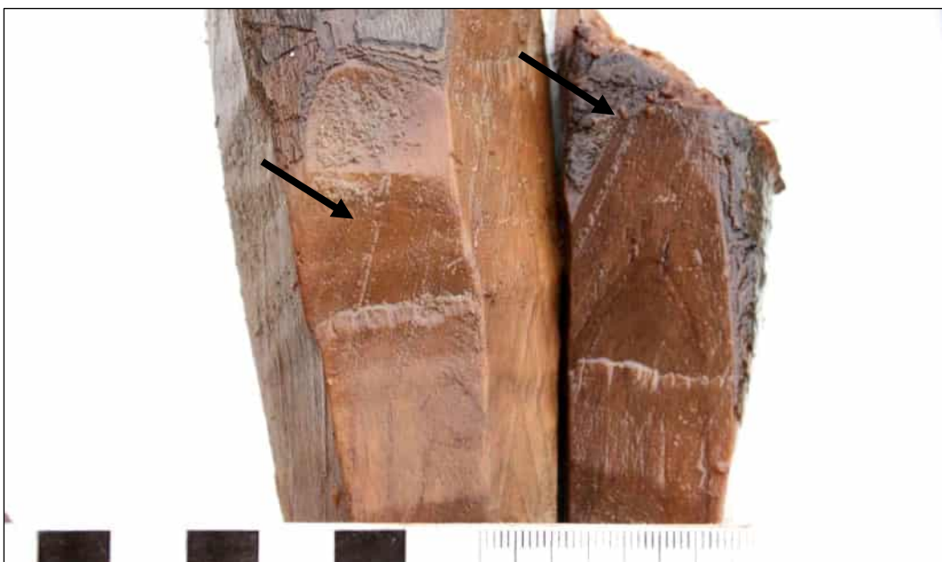
Fig. 8. Twee van de staken met braam (zie pijl) uit S106.24 (© BIAAX Consult).
