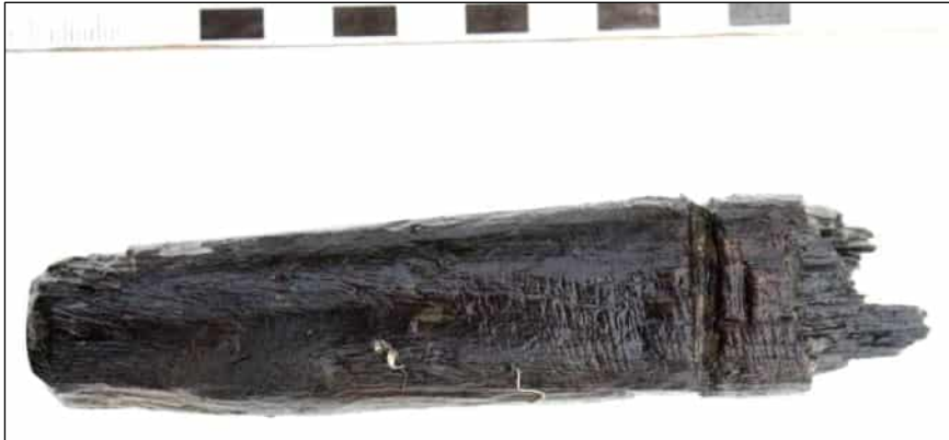
Fig. 20. Deel van een verbindingspen tussen segmenten, S106.26. De pen is ter hoogte van het segment waarin het dickere uiteinde stak, afgebroken. Opmerkelijk is de zaagsnede (© BIAAX Consult).
