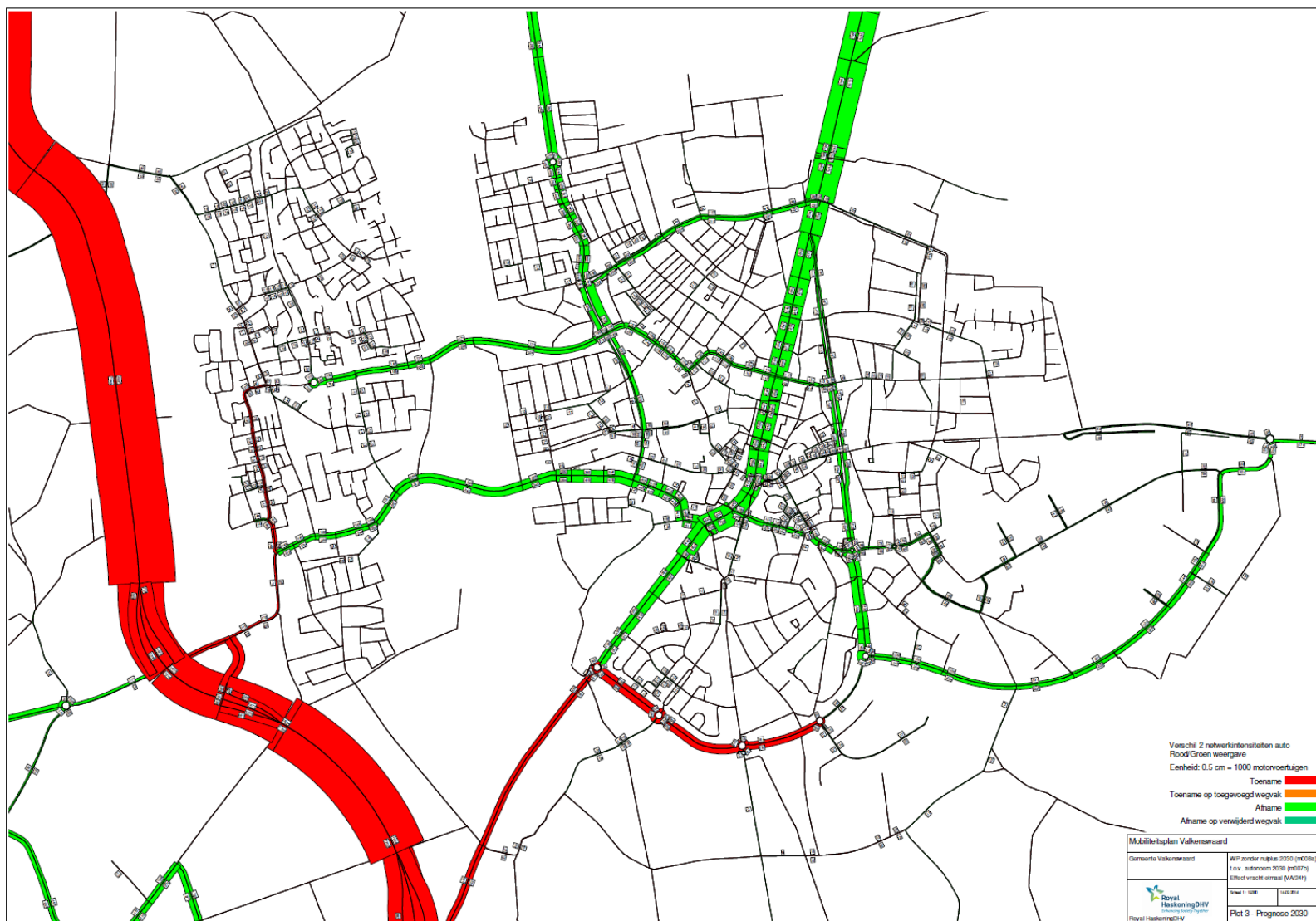
Scenario 2 verschil vrachtverkeerintensiteiten in Valkenswaard tussen autonome ontwikkeling 2030 en situatie met Westparallel en zonder nulplusmaatregelen 2030
