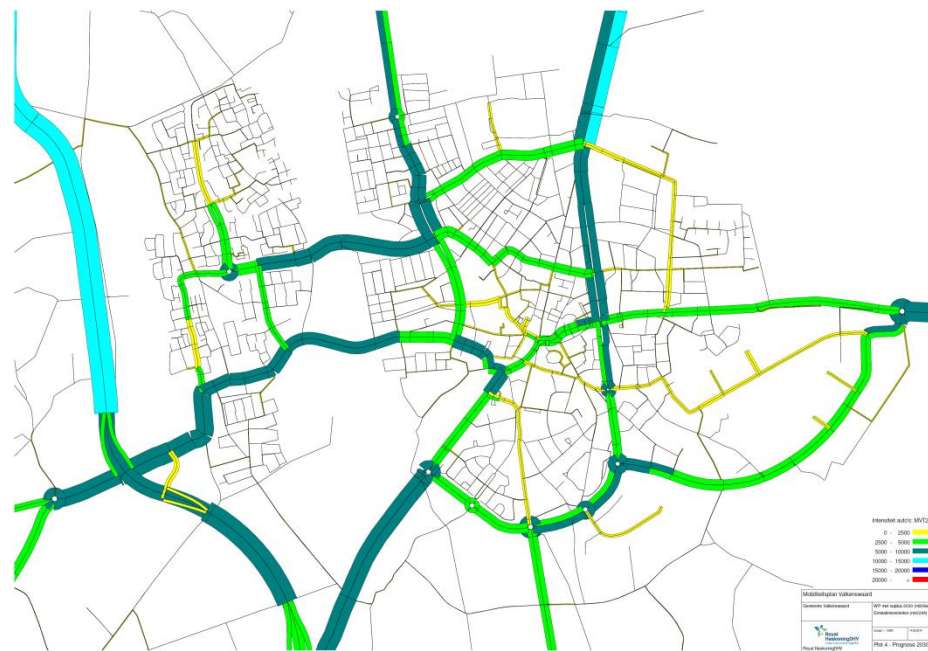
afbeelding 25: scenario 3 verkeersintensiteiten in Valkenswaard in 2030 met Westparallel en met nulplusmaatregelen (Verkeersmodel Regio Kempen, 2014)
