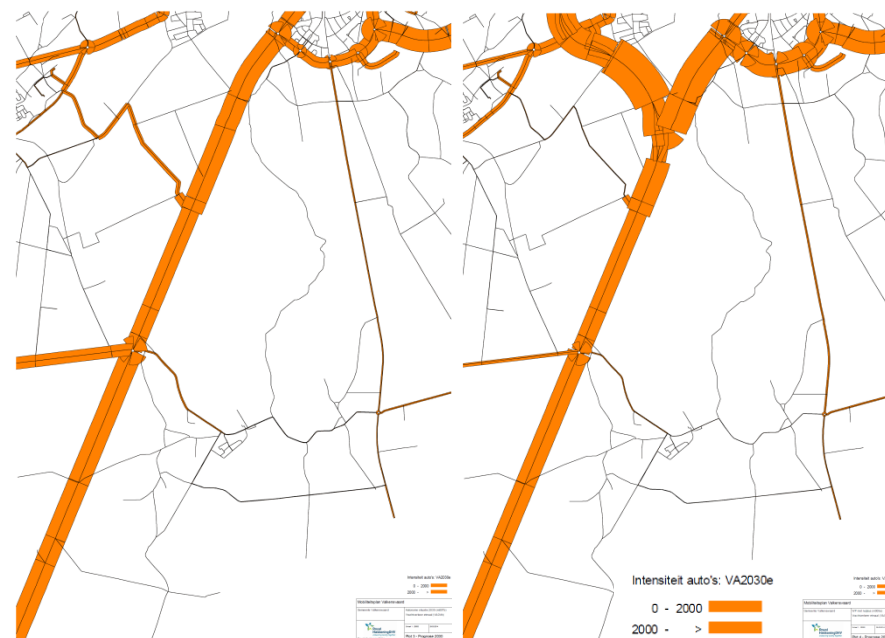
afbeelding 35: links vrachtverkeerintensiteiten bij autonome ontwikkeling 2030 buitengebied Valkenswaard, rechts: vrachtverkeerintensiteiten 2030 bij aanleg Westparallel en nulplusmaatregelen (Bron Royal Haskoning DHV, 2013)
