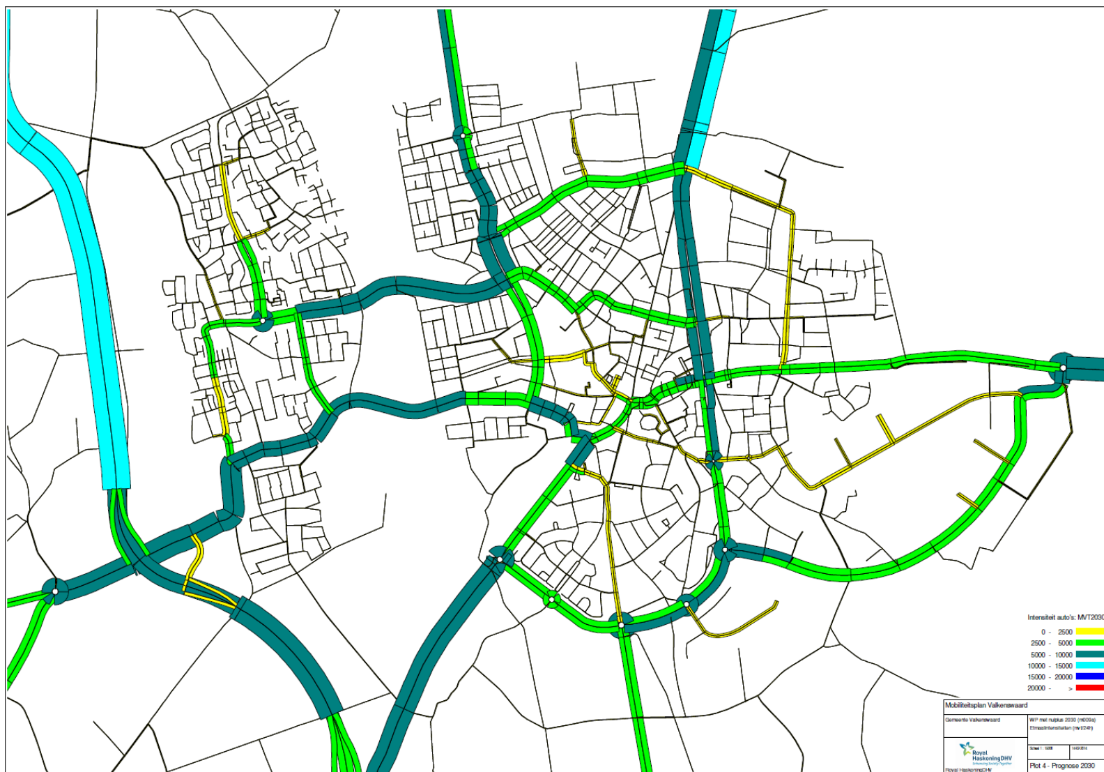
Scenario 3 verkeersintensiteiten in Valkenswaard in 2030 met Westparallel en met nulplusmaatregelen
