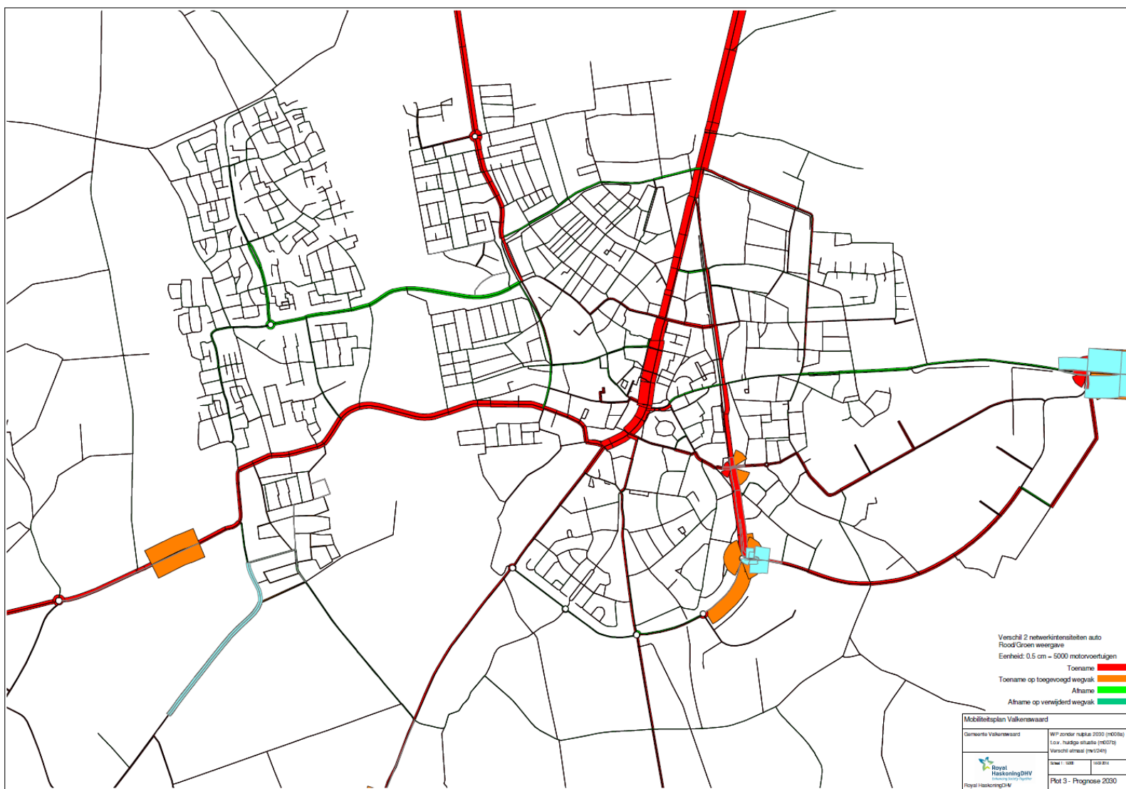
Scenario 1 verschil verkeersintensiteiten Valkenswaard tussen 2013 en 2030 bij autonome ontwikkeling. Rood is verkeerstoename, groen is afname met oranje is aangepast wegvak aangegeven.
