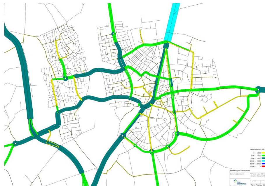
afbeelding 23: scenario 2 verkeersintensiteiten in Valkenswaard in 2030 met Westparallel en zonder nulplusmaatregelen (Verkeersmodel Regio Kempen, 2014)
