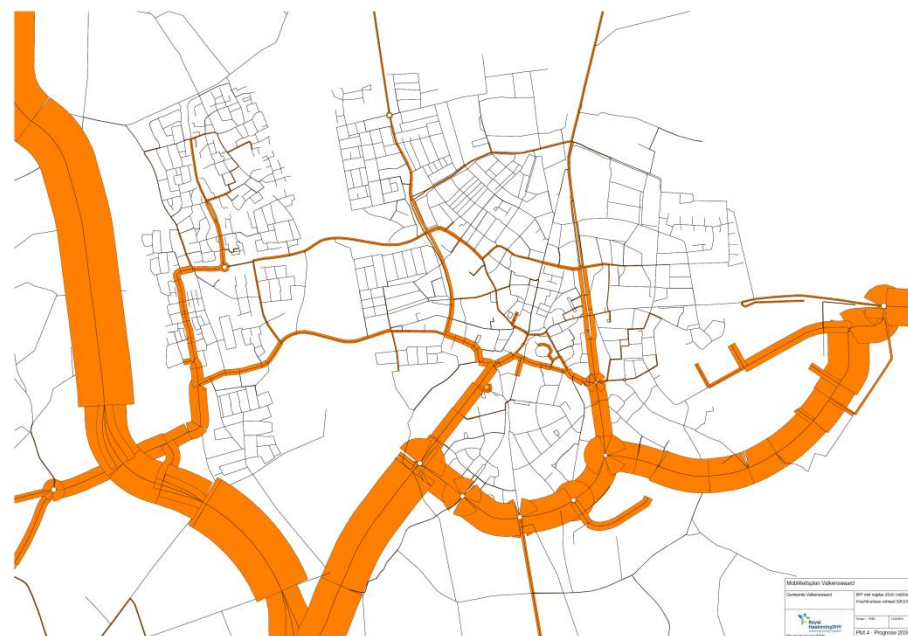
afbeelding 31: scenario 3 vrachtverkeersintensiteiten (in oranje) in Valkenswaard in 2030 met Westparallel en met nulplusmaatregelen (Verkeersmodel Regio Kempen, 2013)
