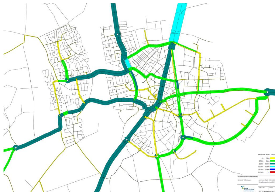
afbeelding 21: scenario 1 verkeersintensiteiten in Valkenswaard in 2030 bij autonome ontwikkeling (Verkeersmodel Regio Kempen, 2013)
