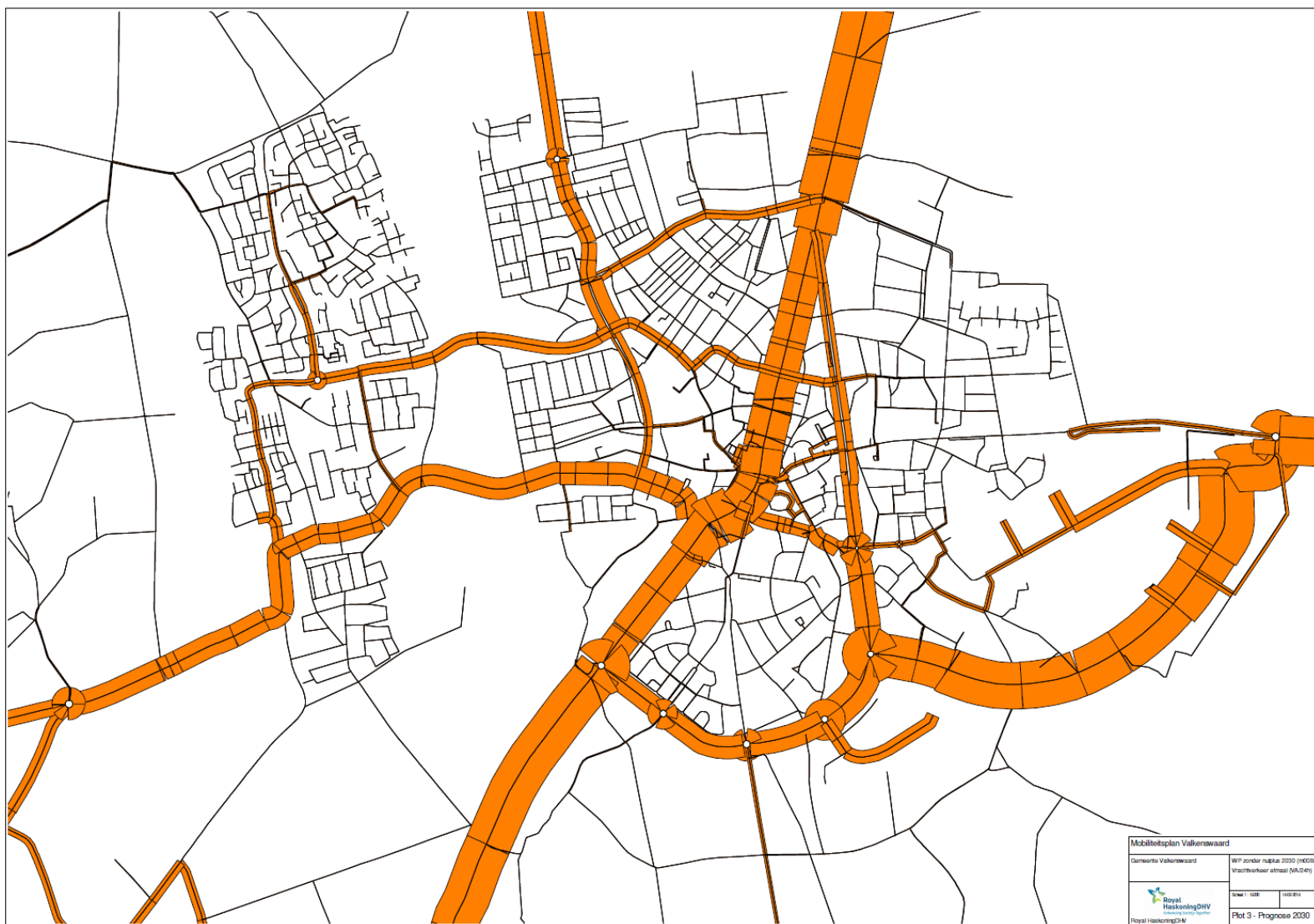
Scenario 1 vrachtverkeerintensiteiten in Valkenswaard in 2030 bij autonome ontwikkeling
