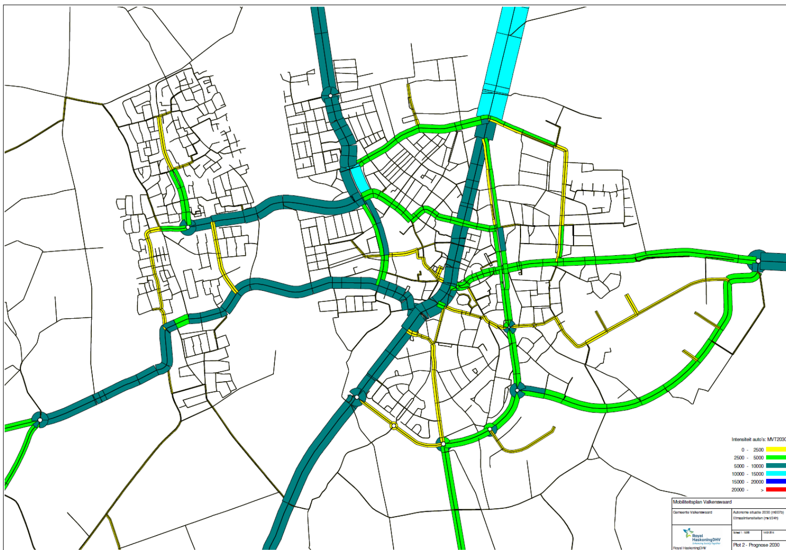
Scenario 1 verkeersintensiteiten in Valkenswaard in 2030 bij autonome ontwikkeling
