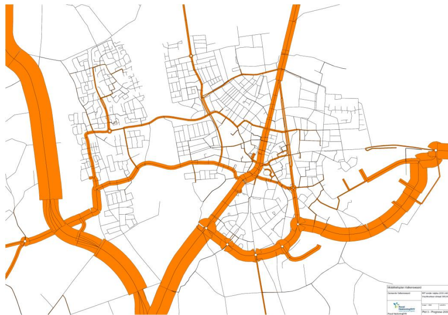
afbeelding 29: scenario 2: vrachtverkeersintensiteiten (in oranje) in Valkenswaard in 2030 met Westparallel en zonder nulplusmaatregelen (Verkeersmodel Regio Kempen, 2013)
