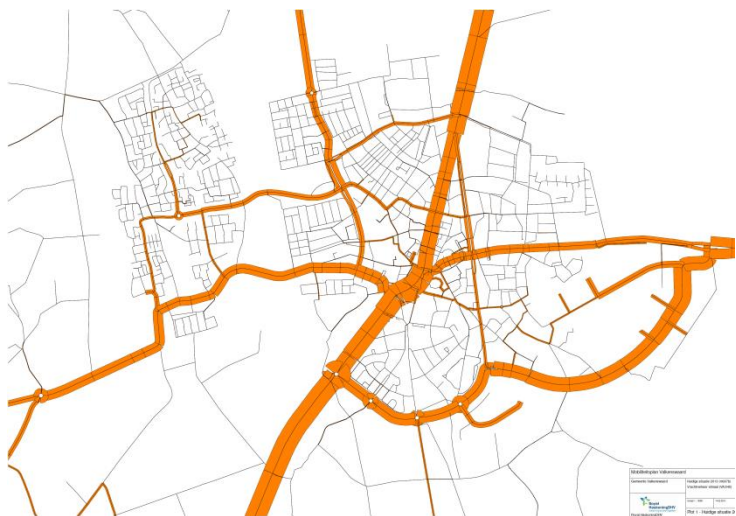
afbeelding 19 en 20: weergave verkeersintensiteiten anno 2013 op Valkenswaardse wegennet op basis van berekening verkeersmodel.
