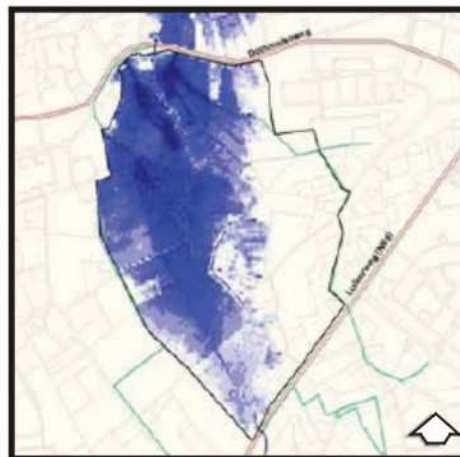
Nieuwe situatie: maximale waterdiepte/ oppervlakte bij een T=10 afvoergolf die voor 30% is geknepen
