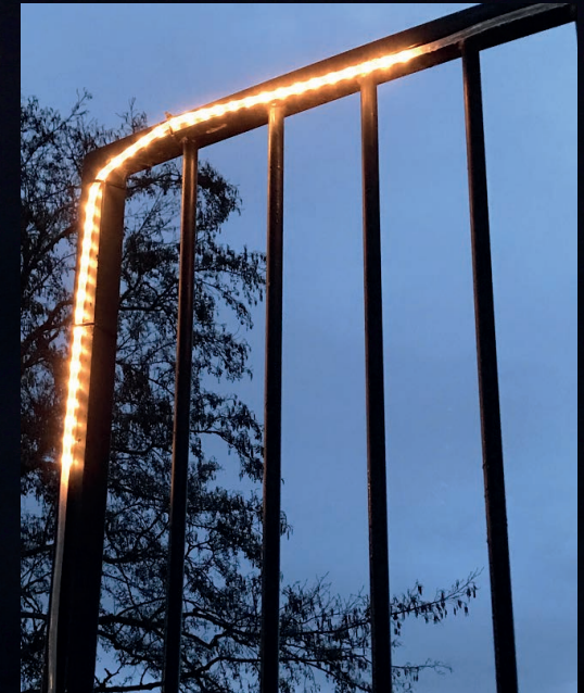
Gebruik van een LEDstrip in een toegangshek van een camping. De strip zorgt ervoor dat het hek in de nacht goed zichtbaar is.
