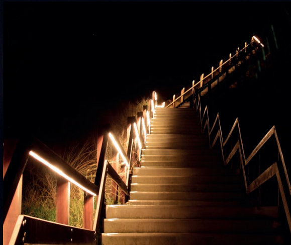
Gebruik van een LEDstrip in een duintrap. Kan ook worden gebruikt voor trappen op camping
