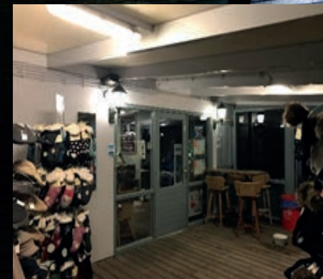
Warmwit licht voor herkenning van mensen en spullen, armaturen uit het zicht van het strand hangen.
