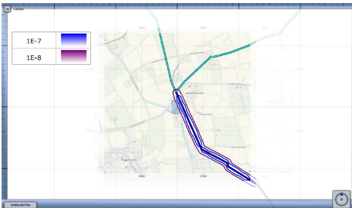
3.2 Figuur 3.3 Plaatsgebonden risico voor 8489_leiding-Z-567-20-deel-1 van N.V. Nederlandse Gasunie
