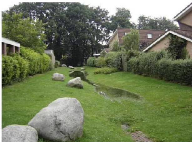
Afbeelding: Wateropvangreservoir (Wadi) in een woonwijk
