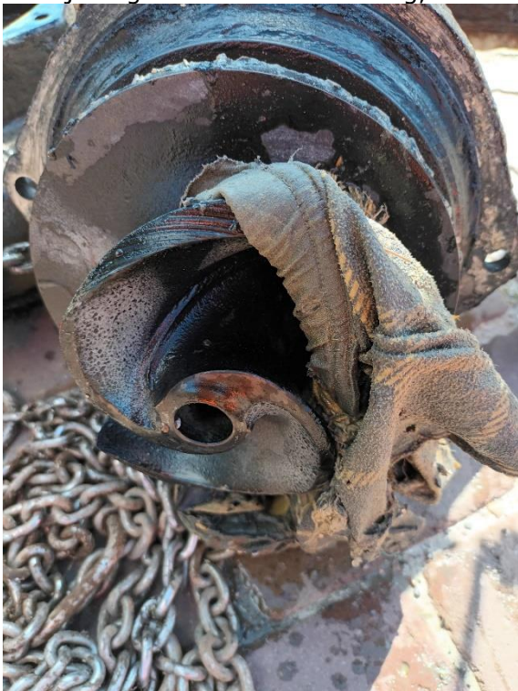
Figuur 1: Doeken zorgen voor verstopping in pomp van Schoolstraat in Aagtekerke.
