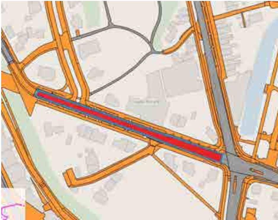
Paul Krugerstraat gedeelte Badhuisstraat – Brouwenaarstraat. Zeer Stil Asphalt / Semi Dicht (ZSA-SD) (ZSA 5 porfier Cariphalt) dik 30 mm. Aannemer KWS. Aanleg 2014. Project 13.020.
