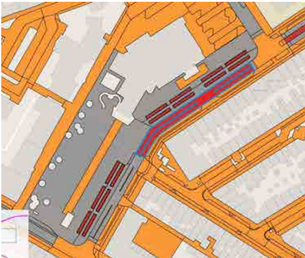
Paul Krugerstraat gedeelte Badhuisstraat – Brouwenaarstraat. Zeer Stil Asphalt / Semi Dicht (ZSA-SD) (ZSA 5 porfier Cariphalt) dik 30 mm. Aannemer KWS. Aanleg 2014. Project 13.020.
