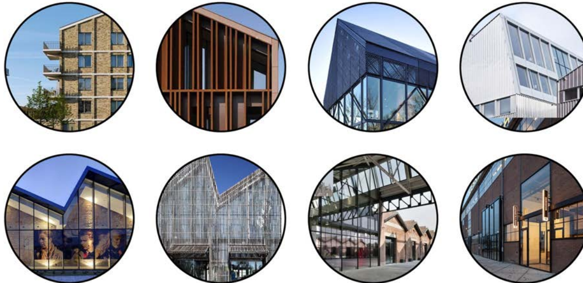
Wereld van de Binnenhavens-De Watersportpier materiaalpalet: Materialen bestaan uit baksteen, staal (cortenstaal), zink, aluminium, glaspanelen en hout. Daarnaast zijn incidenteel loods en van plaatstaal toegestaan waardoor er op de pier een mix ontstaat van toegepaste materialen.
