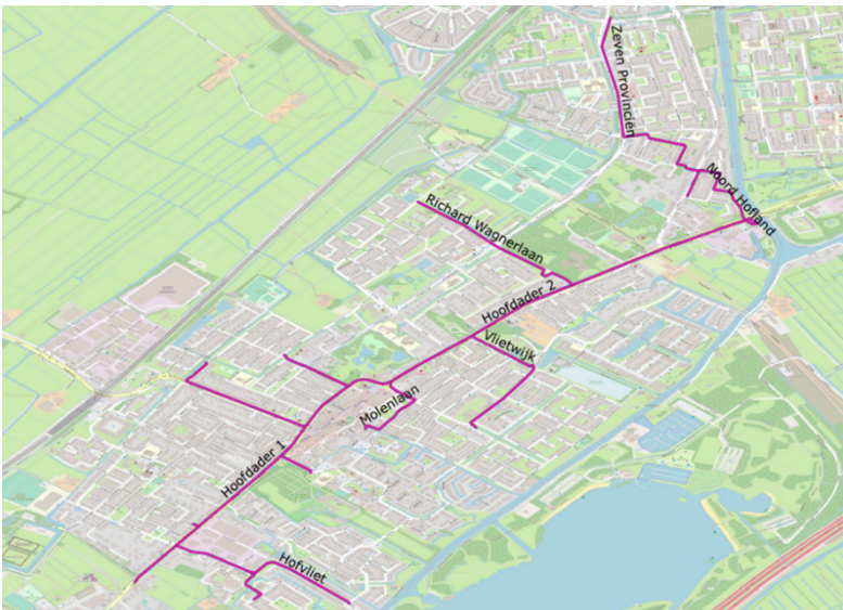
Centrale persleiding waar alle wijkgemalen op inprikken.
