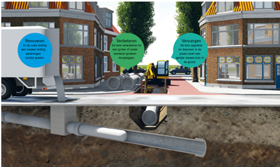
Figuur 5.6.1. Illustratie “vervangingsmaatregelen” (bron Vizualism/Stichting RIONED)
