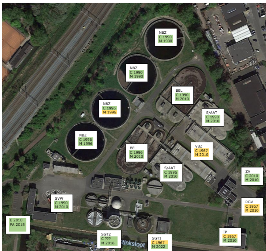
Afb. 5.8.3.3.1: Bouwjaar per installatieonderdeel
