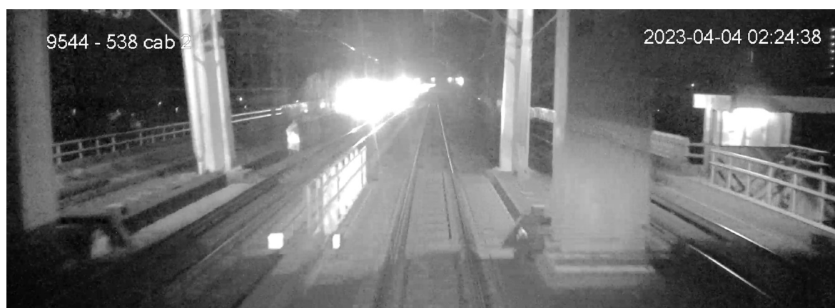
▲ Figuur 55: Fragment van beeld frontcamera trein 1405, rijdende van Leiden in de richting van Den Haag tijdens passage van de Vinkbrug, de fel verlichte plekken zijn de lasbussen van werklocatie 09 en 07. (bron: NS)
