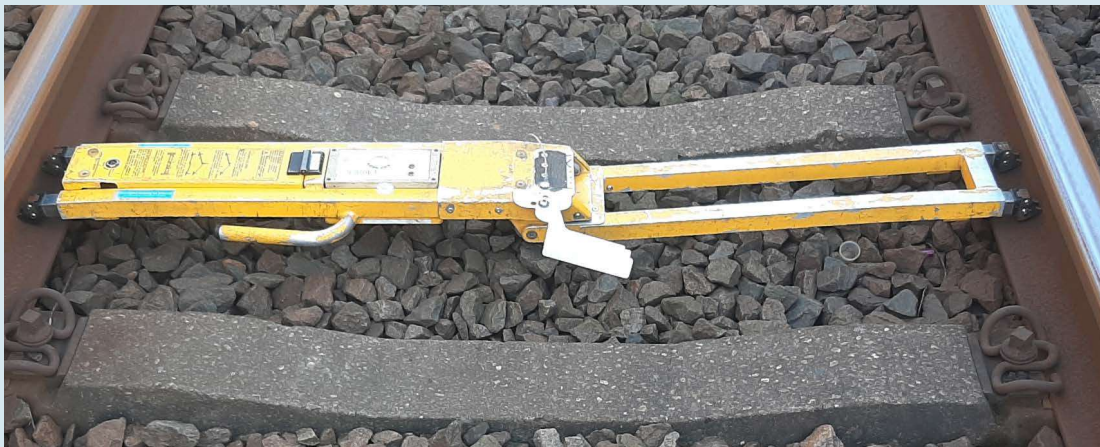
▲ Figuur 10: Zelfsignalerende kortsluitlans (in spoor 3 te Voorschoten)
