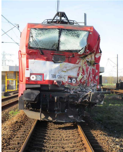
▲ Figuur 18: Beeld van voorzijde locomotief goederentrein 47612 na de aanrijding met de kraan.
