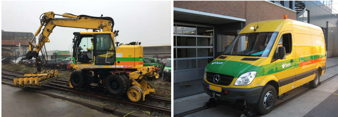
▲ Figuur 4: Voorbeeld van een kraan op lorries met hulpmiddel voor het vervangen van dwarsliggers en een lasbus, beide voertuigen zijn railwegvoertuigen (foto's: BAM).
