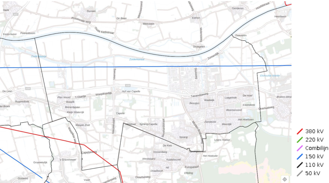
Figuur 55: Bovengrondse hoogspanningslijnen met rekenafstand
