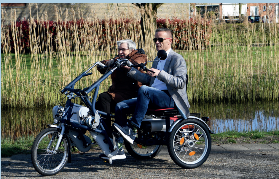
De duofiets van GO Waalwijk heeft elektrische trapondersteuning. De begeleider stuurt en trapt. De duopassagier kan kiezen om wel of niet mee te trappen, afhankelijk van de mogelijkheden.
