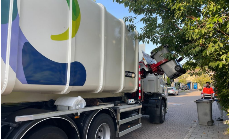
Figuur 1: Inzamelwagen van Avalex met zijbeladingsmechanisme
