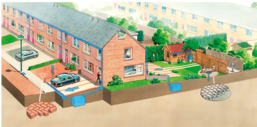
Figuur 5.8.2. Illustratie afkoppelen verharding (bron Rioned)
