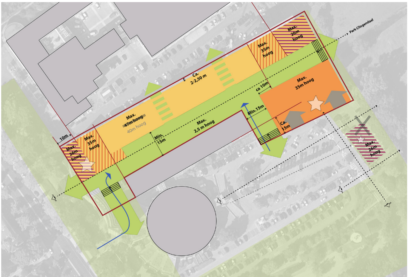
de bouwvelop uit het kader inclusief inmiddels vervallen zoeklocatie en maxime hoogte van 47 meter
