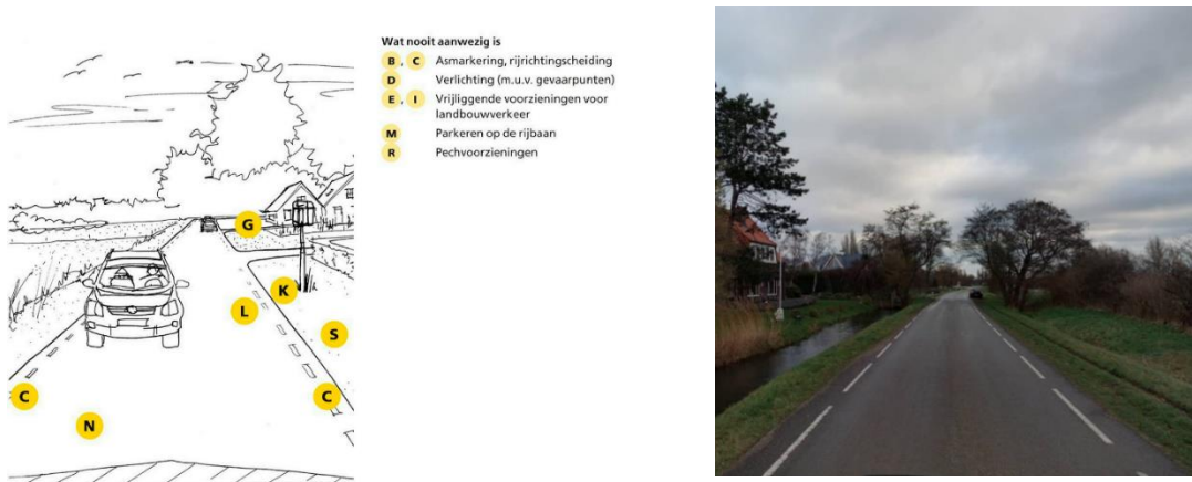
Figuur 8. Ideale inrichting erftoegangsweg buiten de bebouwde kom (ETW-1/60 km/u-zone, CROW publicatie 315) met hogere verkeersintensiteit
