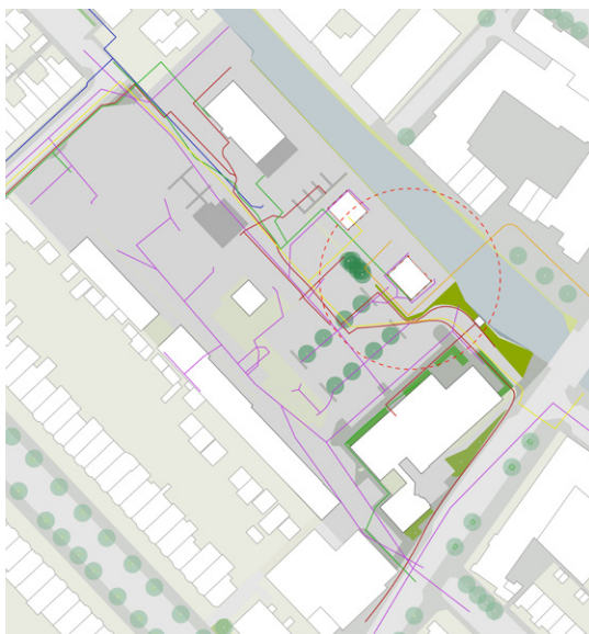
Ondergrondse infra en de hindercirkel van het gastransformatorstation
