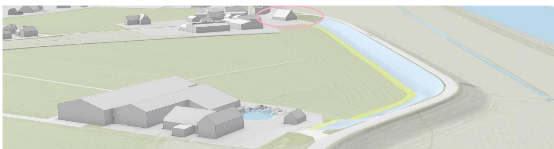
Figuur 5-12 Weergave locatie oplossing in ontwerpvak 3, met in bouw de taludverflauwing en in geel de beheerstrook. De roze cirkel geeft een maatwerkllocatie weer.
