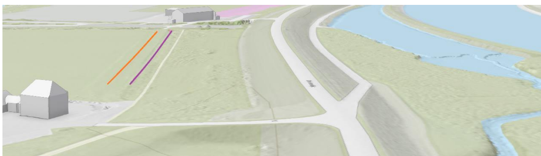
Figuur 5-2 Weergave locatie oplossing in ontwerpvak 1a, de watergang verplaatst van de paarse naar de oranje locatie
