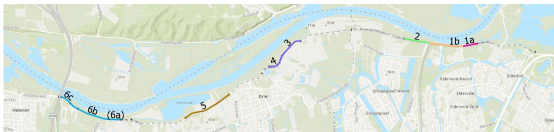
Figuur A-3 Ontwerpvakken in deeltraject Elden-Heteren (gekleurde lijnen), met daartussen strekkingen zonder waterveiligheidsopgave, maar met mogelijke meekoppelkansen voor bijvoorbeeld beheer, verkeersveiligheid en anti-graverij.
