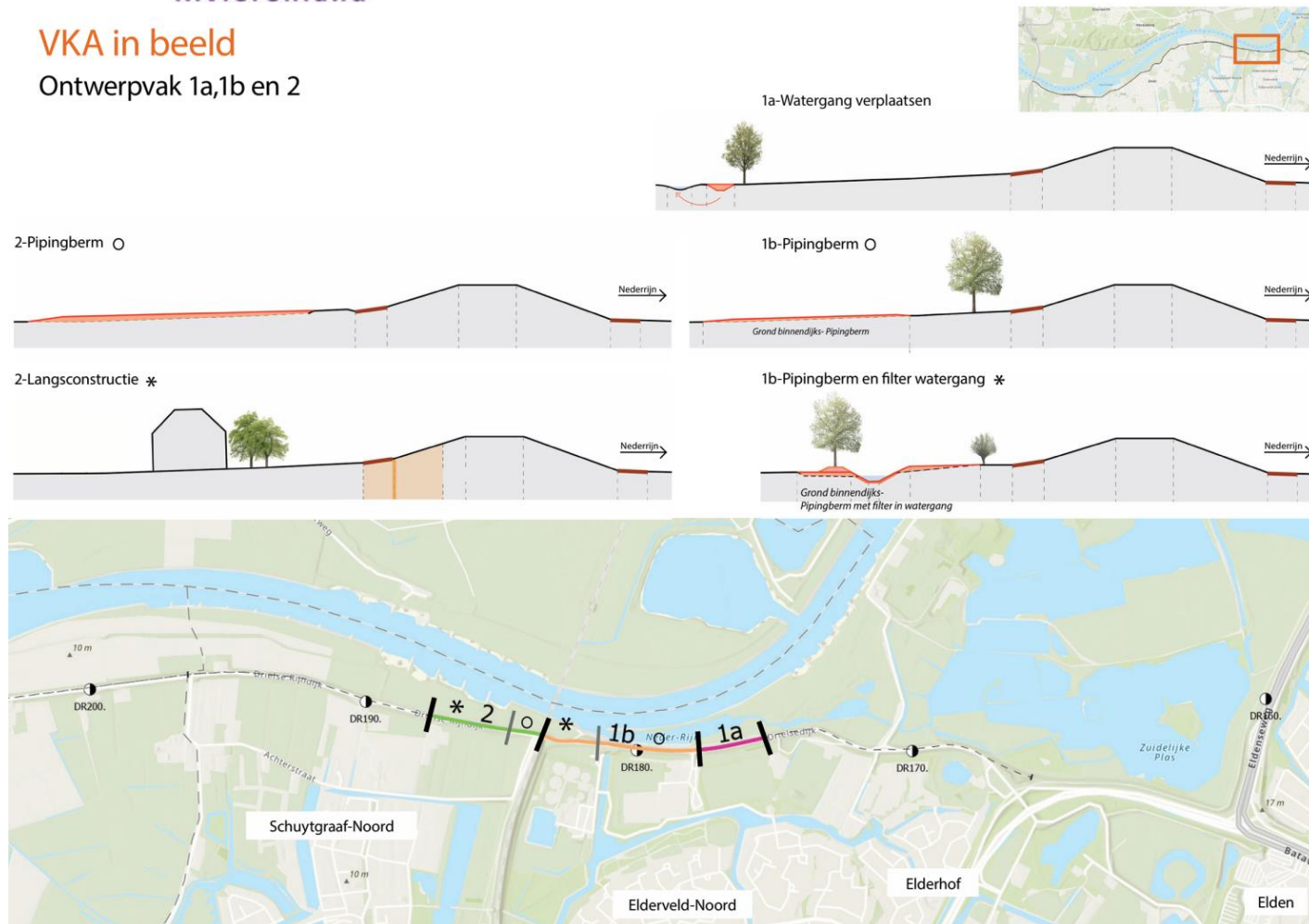
Figuur 2-1 Voorkeursalternatief in beeld, ontwerpvak 1a, 1b en 2 (* en o geven corresponderende vakken en profielen aan), met te onderzoeken locatie voor het terugplaatsen van bomen
