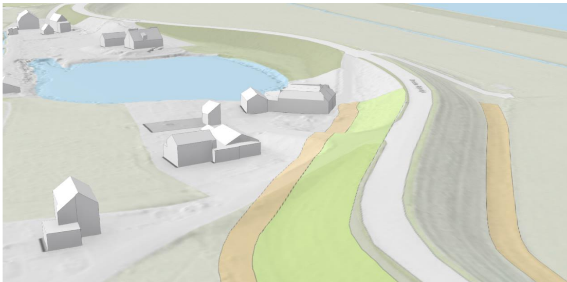
Figuur 5-19 Woningen staan niet in taludverflauwing (in groen) en werkstrook (in oranje)
