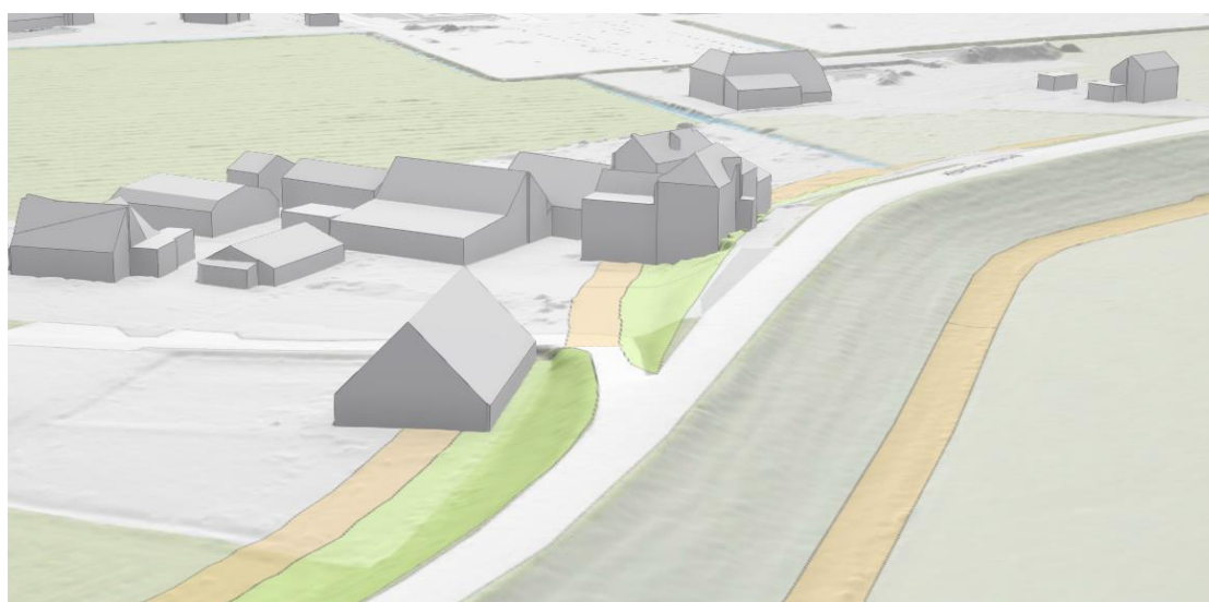
Figuur 5-14 Woning staat in taludverflauwing (in groen) en werkstrook (in oranje)
