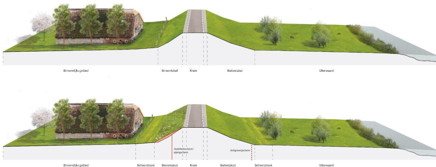
Figuur 0-3 Indicatief principeprofiel van kansrijk alternatief “Vertrouwde dijk”. versterkingsbouwstenen in rood. Het bovenste profiel toont de huidige situatie. (zie voor een grotere weergave pagina 25)
