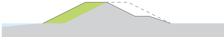
Figuur 4-3 Schematische weergave buitenwaartse dijkversterking (buitenwaartse kruinverlegging)
