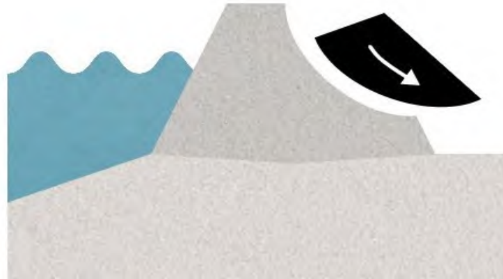
Faalmechanisme van een dijk 2: Macro-instabiliteit binnenwaarts
