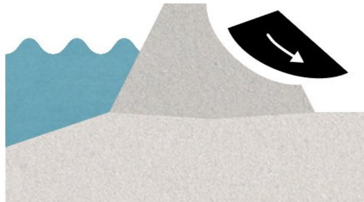
Faalmechanisme van een dijk 2: Macro-instabiliteit binnenwaarts
