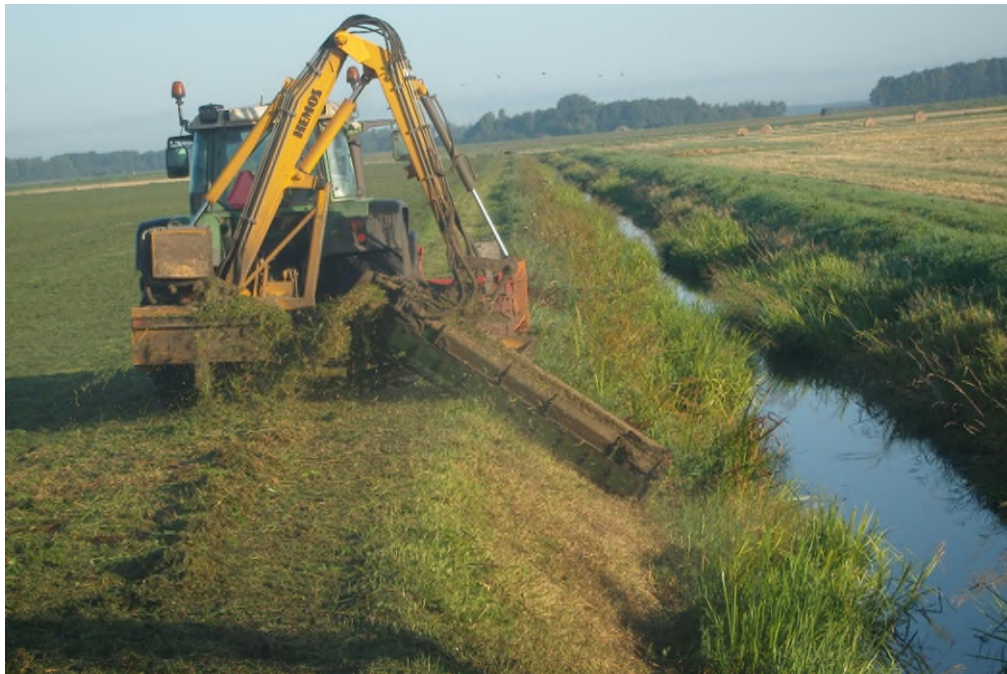
Afbeelding 22 Klepelen droge talud met een transportband
