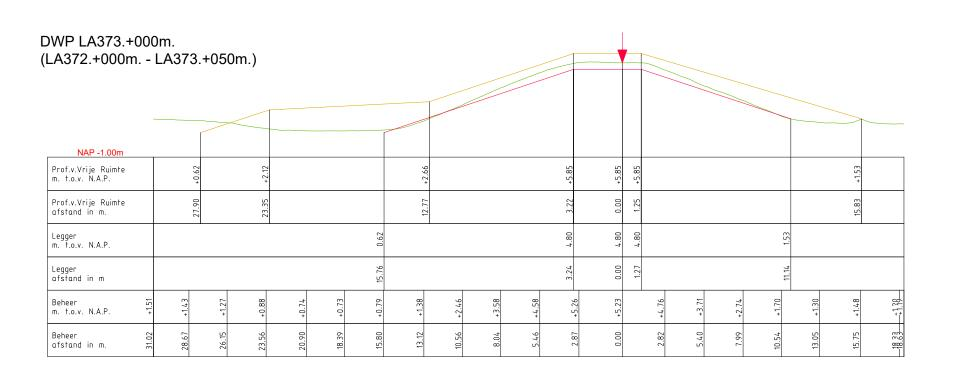
———— Profiel van Vrije Ruimte ♥ Waterkering (Buitenkruin) ———— Leggerprofiel ———— Beheerprofiel
